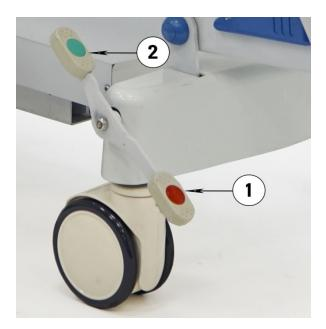
Колесные опоры изделия оборудованы трехпозиционной билатеральной системой блокировки:
