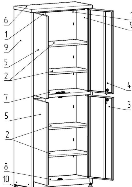
1. Соединить стенки задние поз.1 при помощи винтов и гаек M5. Работы производить на ровной и чистой поверхности.
