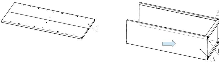
2. Вставить боковые стенки поз.9 в короб нижний поз.8 и закрепить при помощи саморезов 4,2x13.
