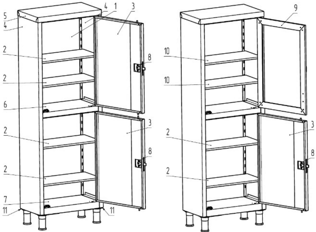
1.Собрать стенки поз.4 с дном поз.7 и полкой средней поз.6 при помощи винтов М5 и шайб. Работы производить на ровной и чистой поверхности.
