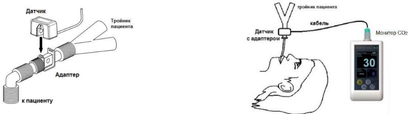
Рисунок 29. Установка датчика и вентиляционного адаптера в дыхательный контур
