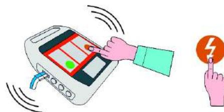
Если в течение 30 секунд кнопка не будет нажата, то аппарат произведет внутренний саморазряд накопленной энергии с предварительным предупреждением «ОСТАЛОСЬ ПЯТЬ СЕКУНД» и предложит провести мероприятия СЛР.
