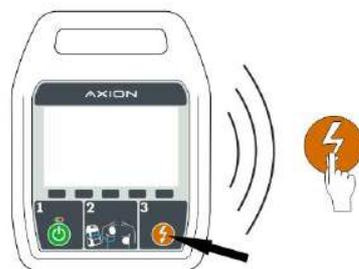
Если в течение 30 секунд кнопка не будет нажата, то аппарат произведет внутренний саморазряд накопленной энергии с предварительным предупреждением «ОСТАЛОСЬ ПЯТЬ СЕКУНД» и предложит провести мероприятия СЛР.
