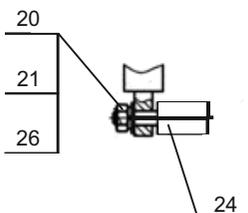
Механизм крепления пневмопружины 8 к основанию кресла 1
