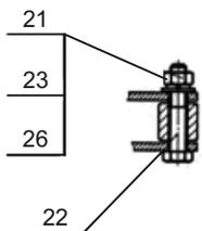
Механизм крепления пневмопружины к сиденью 5
