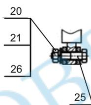
Механизм крепления пневмопружины 9 к кронштейну 27
