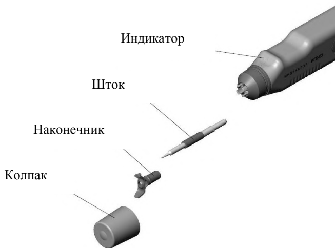
Рисунок 2 – Подготовка индикатора к очистке штокового механизма
