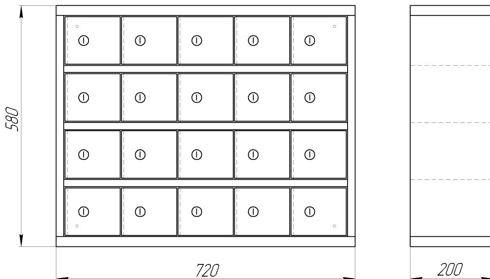
2.2. Шкаф изготовлен из холоднокатаной, листовой стали.
