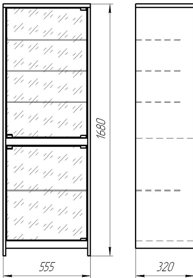
2.2. Шкаф изготовлен из холоднокатаной, листовой стали.
