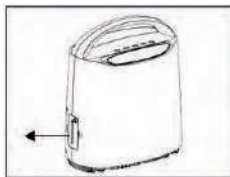
Рис. 13 – Извлечение увлажнителя и место наполнения его водой
