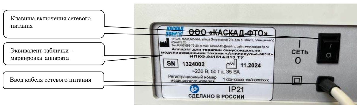
Рисунок 7 – Вид блока электронного АМПЛИПУЛЬС-501К и задней панели с указанием органов управления, индикации и коммутации
