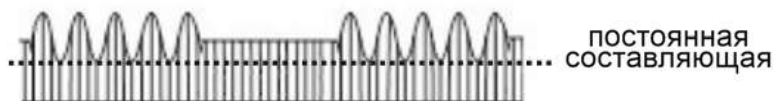
Рисунок Б.8 – Форма сигнала при третьем роде работы для выпрямленного режима положительной полярности.
