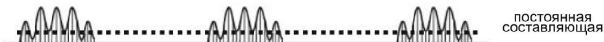
Рисунок Б.5 – Форма сигнала при втором роде работы для выпрямленного режима положительной полярности.
