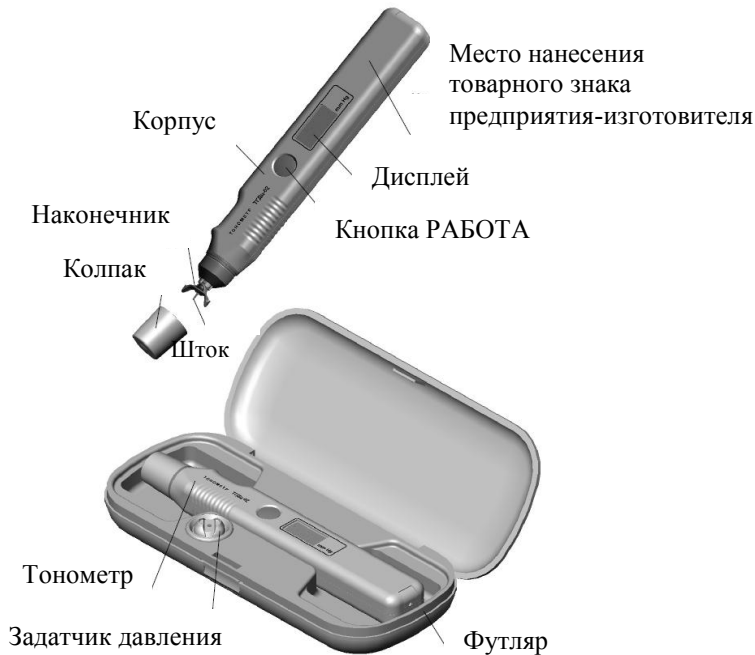
Рисунок 1 – Внешний вид тонометра ТГДц-03
