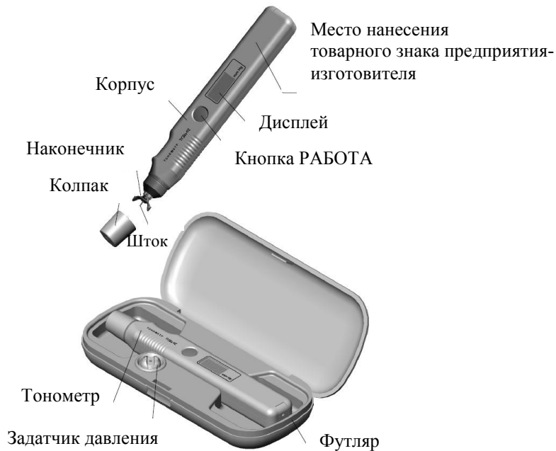
Рисунок 1 – Внешний вид тонометра
