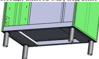
5. Крепить короб средний к боковым и задней стенке при помощи винта М5х12. Устанавливать шайбу 5.
