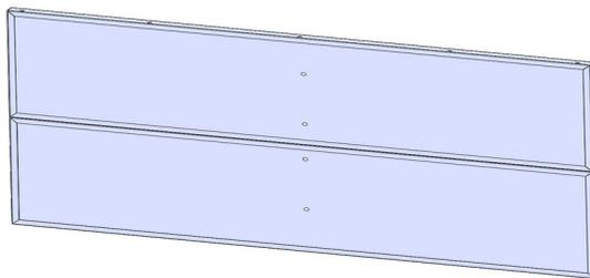
2. Крепить боковые стенки левую и правую к задней при помощи винта М5х12. Устанавливать шайбу 5.
