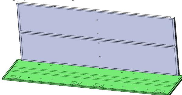
3. Крепить дно к боковым и задней стенке при помощи винта М5х12. Под винт устанавливать шайбу 5.
