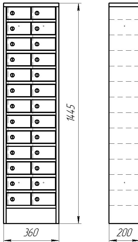
2.2. Шкаф изготовлен из холоднокатаной, листовой стали.
