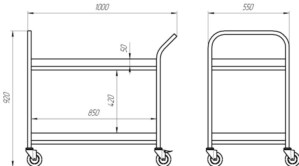
2.2. Каркас тележки выполнен из профильной трубы.
