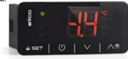
Температурный режим в холодильнике установлен производителем от - 1°C до + 5°C., дифференциал равен 6. (т.е. при установке температуры на табло эл. контроллера - 1°C, температура в холодильной камере будет поддерживаться от - 1°C до + 5°C , при установке 0°C соответственно от 0°C до + 6°C).
