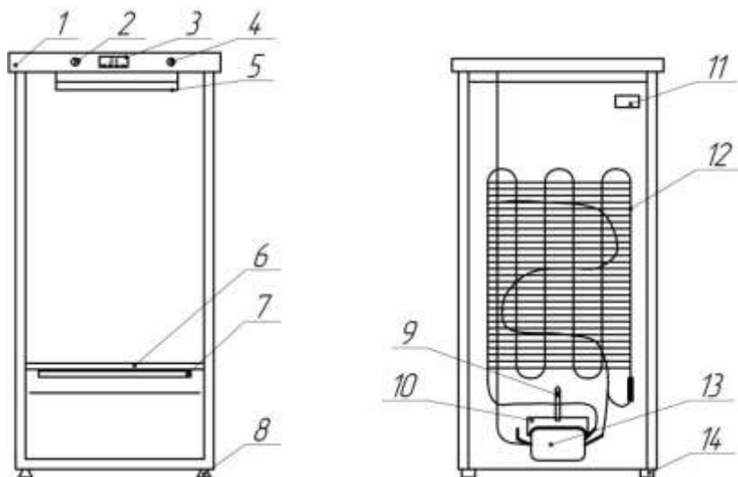
1 – крышка-столешница, 2 – замок, 3 – электронный контроллер температуры , 4 – вкл./выкл. лампы, 5 – лампа бактерицидная, 6 – полка, 7 – воронка, 8 – опора передняя, 9 – трубка сливная, 10 – сосуд для испарения талой воды, 1 – табличка информации, 12 – конденсатор, 13 – мотор-компрессор, 14 – опора роликовая.
