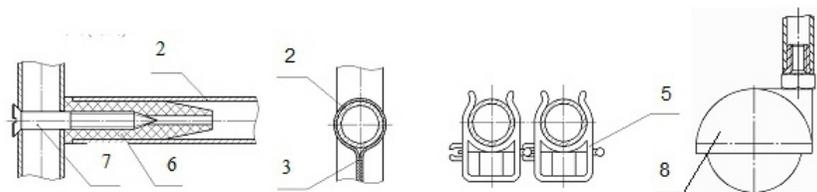
1-каркас; 2,4-труба; 3-полотно; 5-соединительная защелка;
