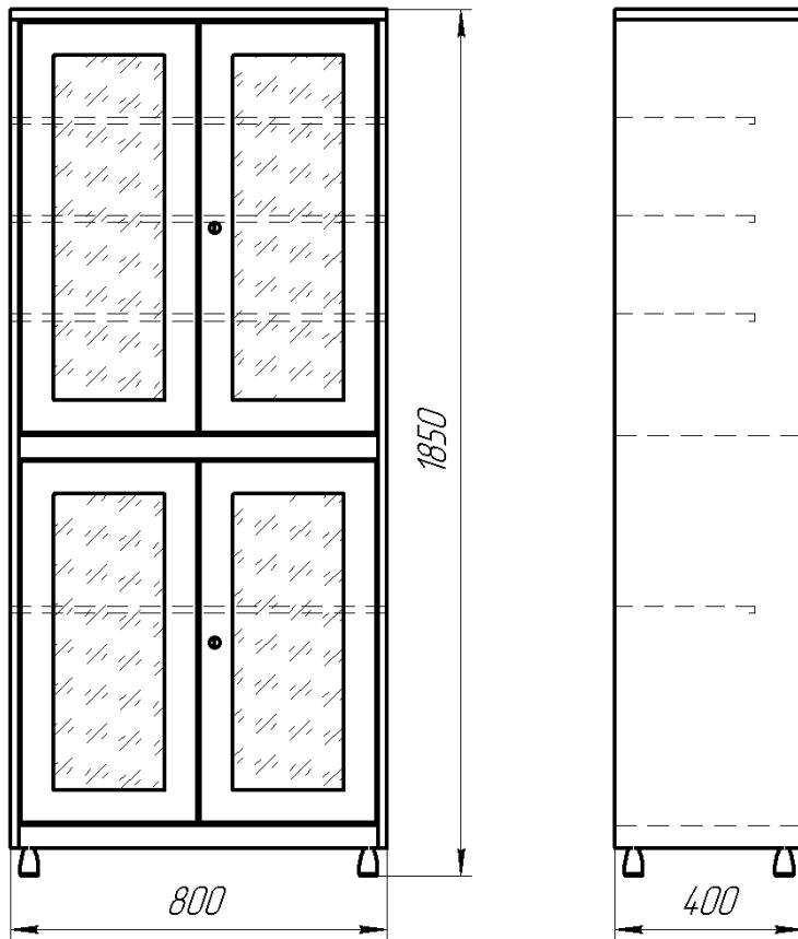
2.2. Шкаф изготовлен из холоднокатаной, листовой стали.
