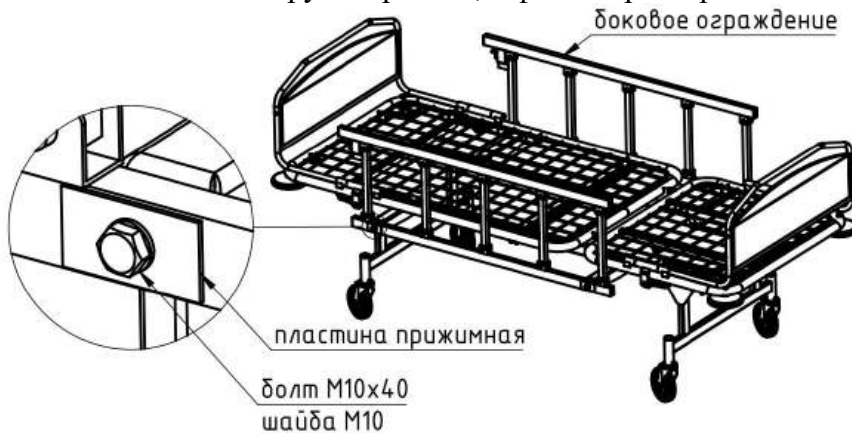
Рисунок 14 – Установка боковых ограждений на кронштейны
