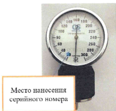
Рисунок 15 – Место нанесения серийного номера
