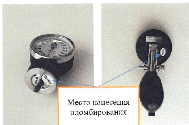
Рисунок 16 – Место нанесения пломбирования от несанкционированного доступа
