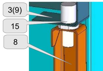
3. Соединить при помощи винтов М5 и шайб полку среднюю (3) к боковым стенкам, предварительно вставив в нее втулку ПВХ(15).
