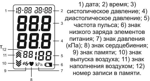
Рис. 18 – Тонومتر электронный «Armed», варианты исполнения: YE660B, YE655D (дисплей), где
