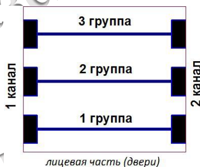
Рис. 2 Схема коммутации розеток для подключения зарядных устройств
