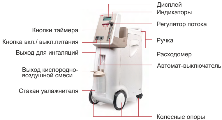
Рисунок 2 - основные элементы концентрактора вариантов исполнения 9F-3W, 9F-5W
