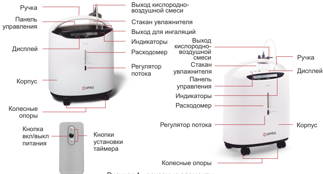
Рисунок 4 - основные элементы концентратора вариантов исполнения 8F-5AW, 8F-3A
